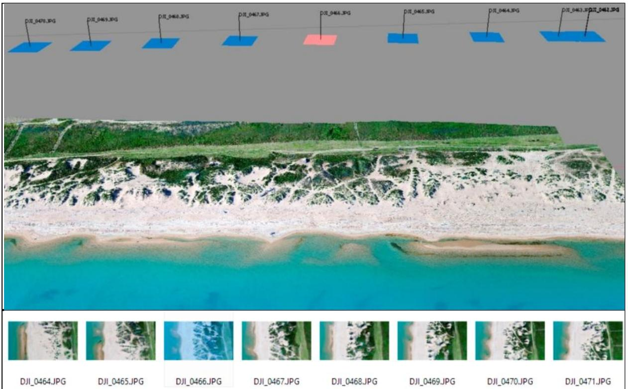
Рис. 1.11 – Схема расположения камер при плановой аэрофотосъемке берега
