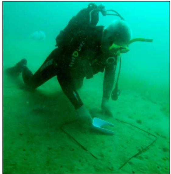
Рис. 1.5 – Отбор проб для определения содержания раковинных моллюсков
