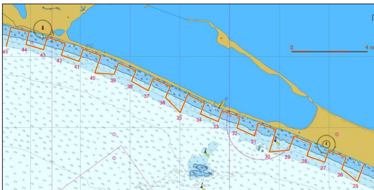
Рис. 1.2 – Батиметрическая съемка: схема промерных галсов в СЗ части полигона
