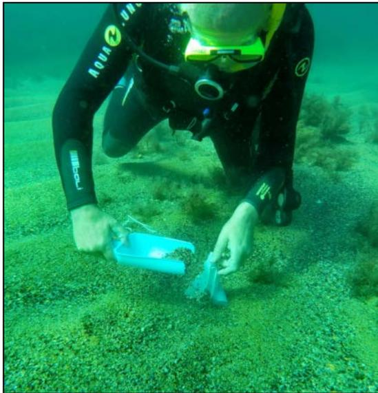
Рис. 1.4 – Отбор проб донных отложений на механиз
