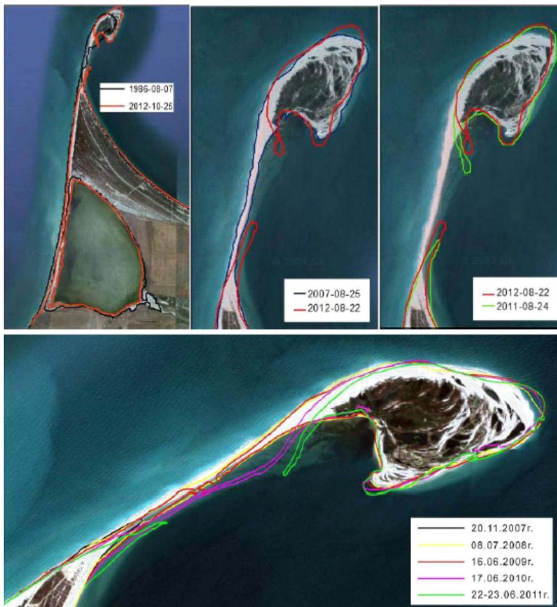
Рис. 3.10 – Изменения конфигурации Бакальской косы по данным ИСЗ серии LANDSAT (вверху) и съемок GPS (внизу)
