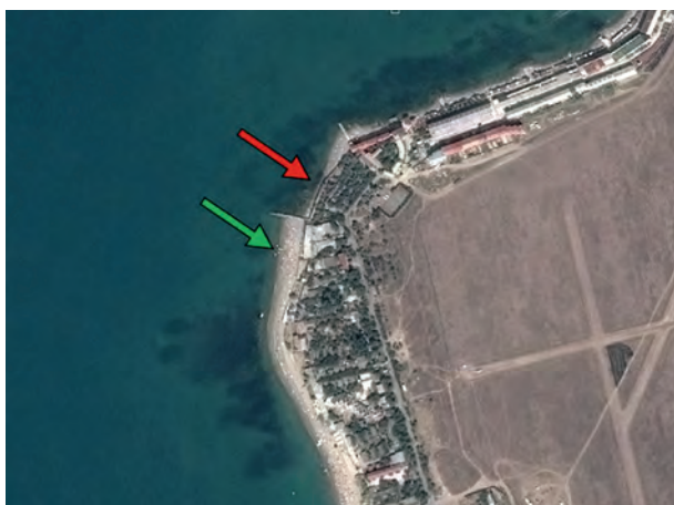
Рис. 5. Северная часть Николаевки (снимок из космоса 27.08.2013 г.). Вдольбереговой поток наносов здесь направлен на север, поэтому две буны удерживают пляжный материал к югу от них, но практически не пропускают его к северу
